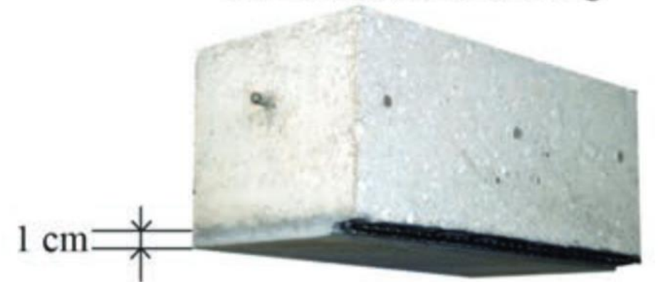
Renforcement par béton carbone
