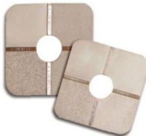
Photo 32 : Évaluation de la rugosité après décapage
