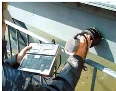
Photo 46 : Mesure de la couleur par colorimètre tri-stimuli
