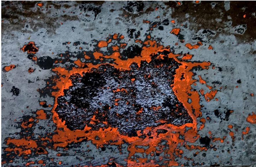
*Photo 9 : Vue des anciens fonds sur un ouvrage revêtu de peinture ancienne à base de minium de Plomb © Lassarat*
