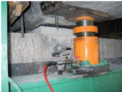
a) Vérin à fort tonnage. Noter le capteur de déplacement, la bague de sécurité (dont il serait souhaitable qu'elle soit à proximité du corps du vérin) et les flexibles souples. Crédit photo P. DANTEC - LRPC de Clermont Ferrand
