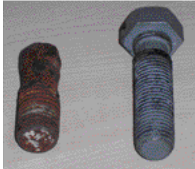
Figure 10 : A gauche, état de corrosion d'une vis fusible de BN4 par rapport à son état neuf, à droite. Crédit photo M. Fragnet
