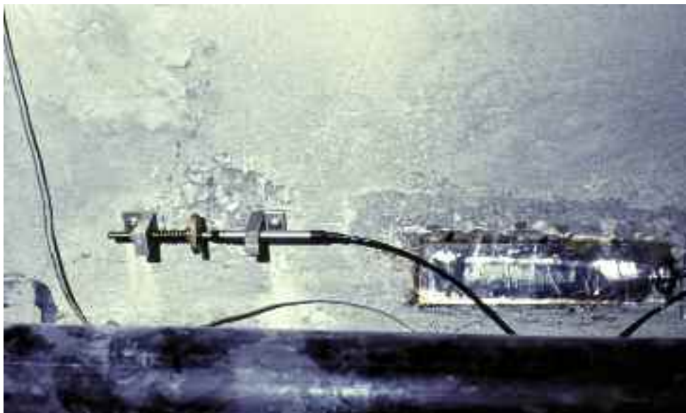
Photo n° 125 : couple jauge - capteur (crédit photo D. Poineau)
