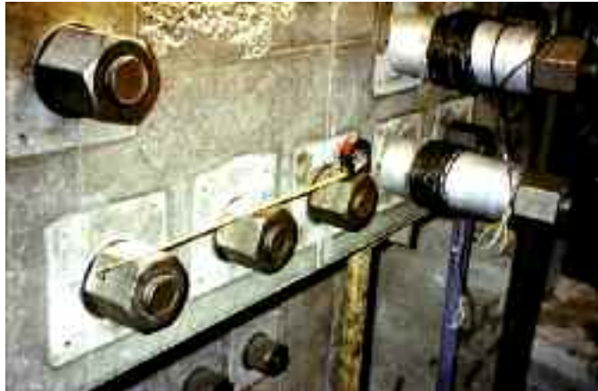
Photo n° 96 : capteurs de force équipant deux barres de précontrainte au viaduc d'Oléron (crédit photo D. Poinneau)
