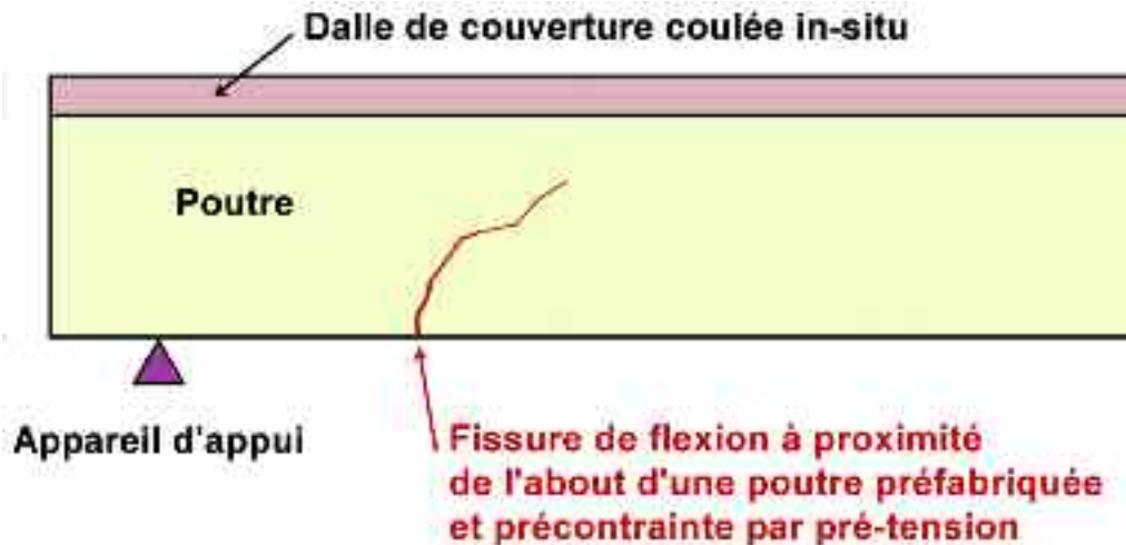
Figure n° 5 : fissure à proximité de l'about d'une poutre PRAD
