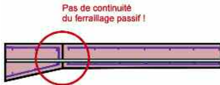
Figure n° 84 : absence de continuité du ferrailage transversal du hourdis
