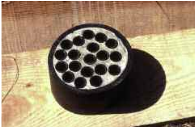
Photo n° 62 : coupe d'un câble constitué de torons gainés-protégés dans un conduit PEHD injecté (photo LRPC)
