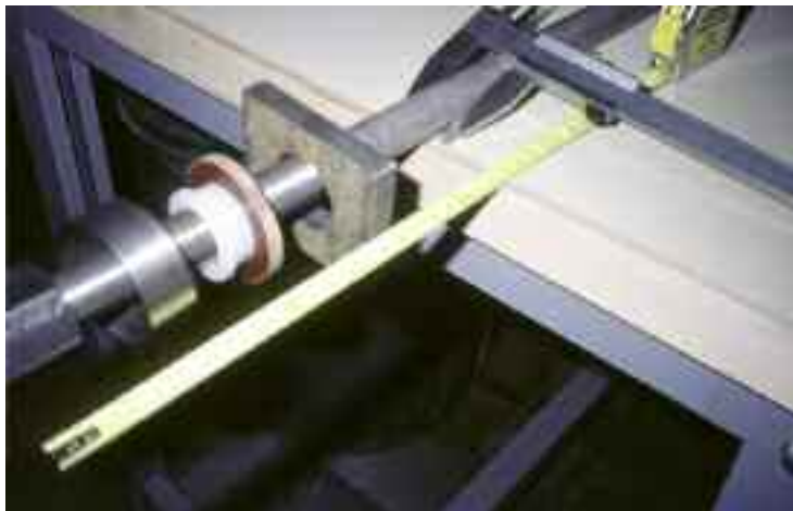
Photo n° 64 : unité de précontrainte en acier inoxydables avec ses bagues isolantes (crédit photo D. Poinneau)
