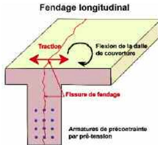
Figure n° 26 : fendage longitudinal d'une poutre préfabriquée précontrainte par pré-tension
