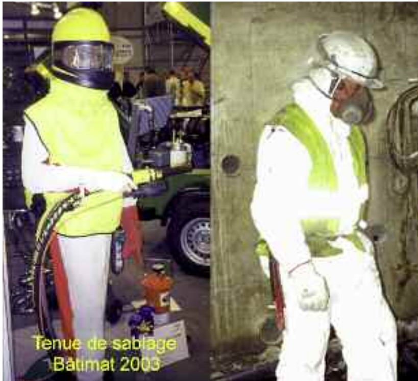
Photo n° 154 : équipements de protection individuelle (crédit photo D. Poineau)
