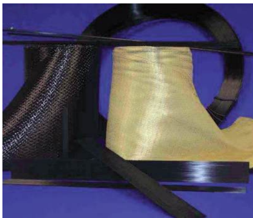
Photo n° 44 : différents matériaux composites (crédit photo Freyssinet - C. Tourneur)
