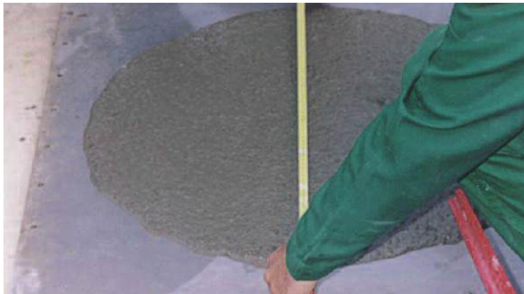
Photo n° 17 : contrôle d'étalement d'un BAP (crédit photo LRPC Clermont - M. Geoffrey)
