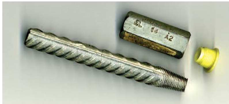
Photo n° 10 : manchon de jonction nécessitant un filetage de l'armature (crédit photo D. Poineau)
