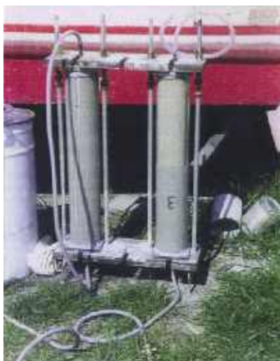
Photo n° 27 : essais avec deux colonnes de sable (crédit photo A. Bouineau)
