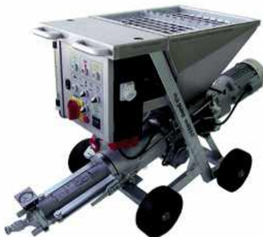
Photo n° 51 : pompe d'injection du système MAI (crédit photo Atlas Copco)
