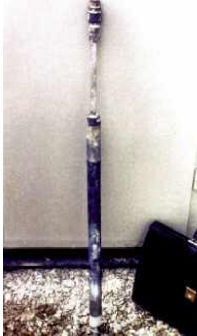
Photo n° 25 : tube à manchette équipé d'un capteur de pression (crédit photo A. Bouineau)
