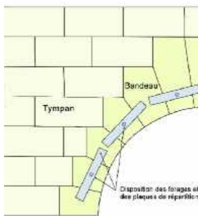
Figure n° 52 : disposition des plaques de répartition (attention à leur protection)
