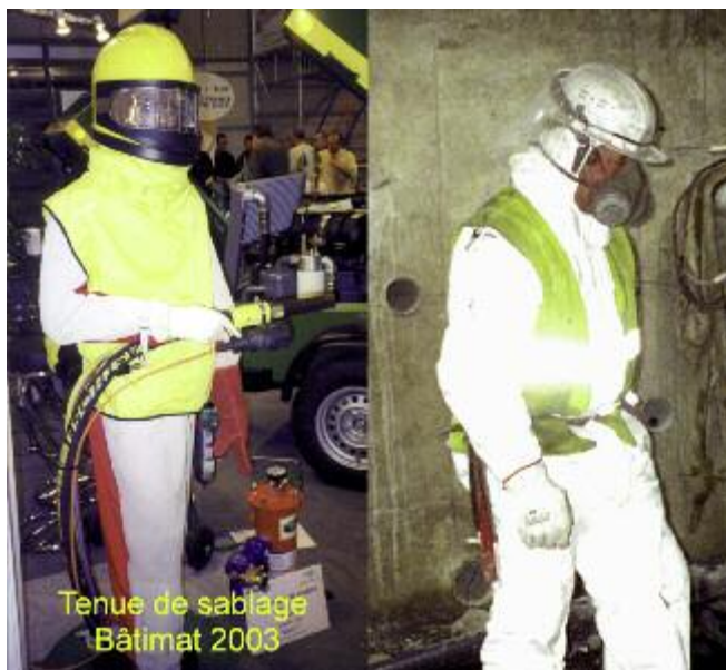
Photo n° 66 : équipements de protection individuelle (crédit photo D. Poineau)
