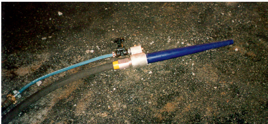
Lance avec sortie de 25 mm pour projection par voie sèche
