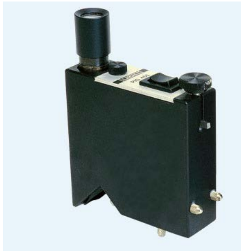
Photo n° 44 : microscope pour le contrôle de l'épaisseur d'un revêtement après séchage (crédit photo Erichsen)
