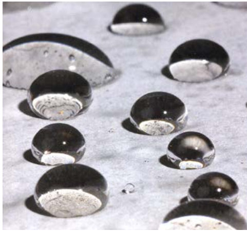
Photo n° 16 : support béton après traitement par imprégnation hydrophobe (crédit photo SIKA)
