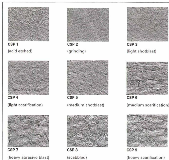
Figure 2.3 : Classification de la rugosité de la surface avant réparation (Guide ICRI 03732)
