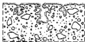
Imprégnation hydrophobe (également appelée hydrofuge de surface)
