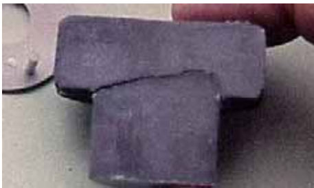
Fig. 73 : Coupe d'un boulon HR galvanisé rompu par fragilisation par l'hydrogène. Rupture sous tête (photo Jean-Paul PERSY).
