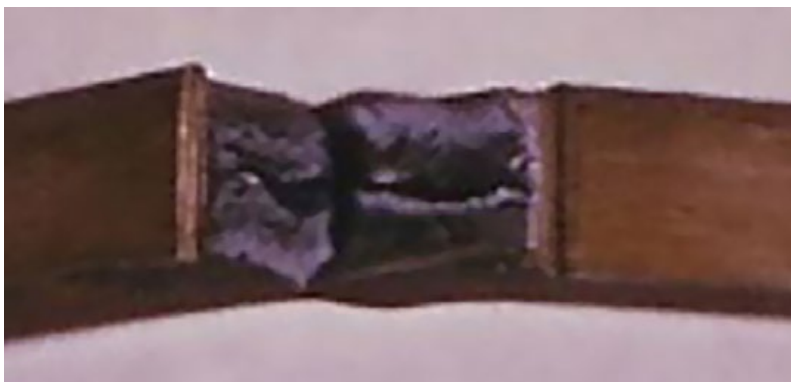
Fig. 24 : Porosité dans la masse d'un acier des années 1970 env. (photo Jean-Paul PERSY).
