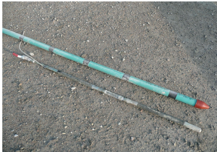
Photo n° 1 : tube à manchette/obturateur double (photo Solétanche-Bachy).
