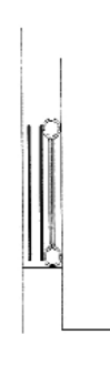
Figure 43 b : Utilisation d'un vérin plat mis en pression et laissé en position « gonflé » par un remplissage en résine ou en coulis de ciment. Document ENPC (référence 2.2.13)
