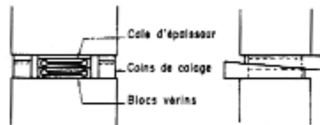
Figure 17 : Disposition de calage de sécurité autour d'un bloc de soulèvement par vérin plat. Document FREYSSINET
