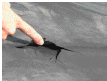
a) Déchirure par vieillissement du matériau
