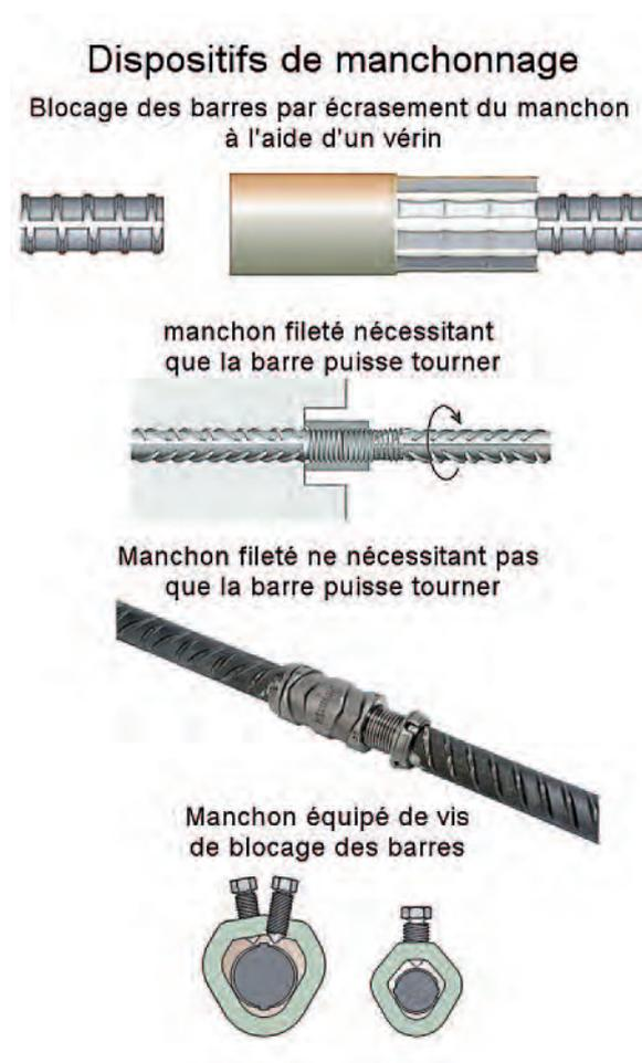
Figure n° 26 : schémas de différents dispositifs de manchonnage
