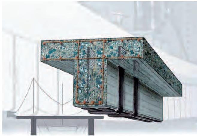
Figure n° 42 : schéma d'un dispositif permettant d'assurer la continuité du renfort de l'âme vis-à-vis de l'effort tranchant - Système «Sika Carboshear L» (crédit photo Sika)
