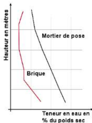
Figure n° 8 : résultats de mesures de teneur en eau dans un mur
