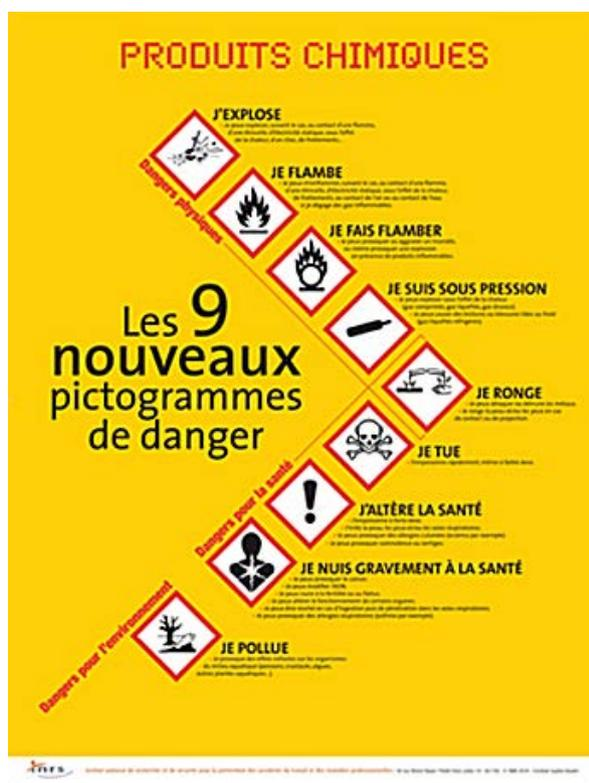
Figure n° 30 : pictogrammes CLP de la nouvelle réglementation sur l'étiquetage extrait d'un document **INSROPPBTB** (crédit photo **INSOPBTB**)
