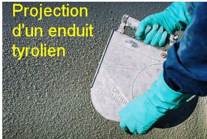
Photo n° 25 : machine à projeter manuelle dite « Tyrolienne™ »
