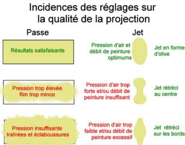
Figure n° 24 : incidences des réglages sur la qualité de la projection
