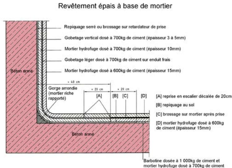
Figure n° 17 : cuvelage avec revêtement épais en mortier (extrait de la norme-DTU 14.1)
