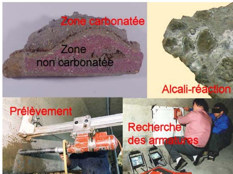
Photo n° 10 : différents essais d'évaluation de l'état d'un support
