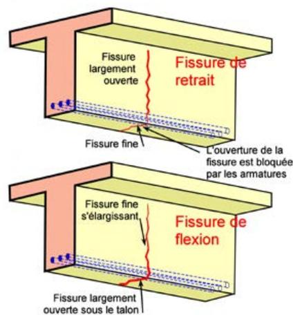
Figure n° 7 : comment différencier une fissure due aux différents retraits d'une fissure de flexion
