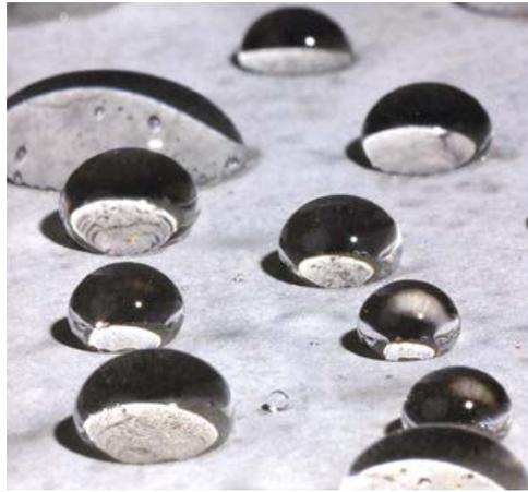
*Photo n° 16 : support béton après traitement par imprégnation hydrophobe
