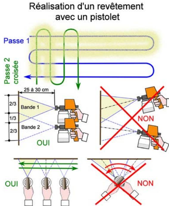
Figure n° 23 : méthodologie de projection d'un revêtement au pistolet
