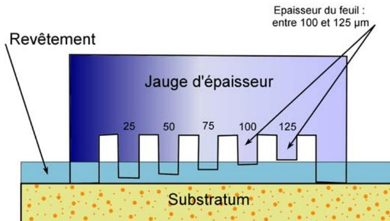
Figure n° 27 : contrôle de l'épaisseur d'un feuil humide avec une jauge à peigne
