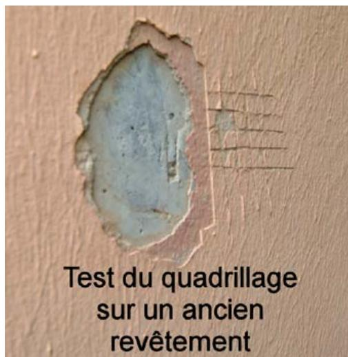
Photo n° 13 : test du quadrillage sur un revêtement existant
