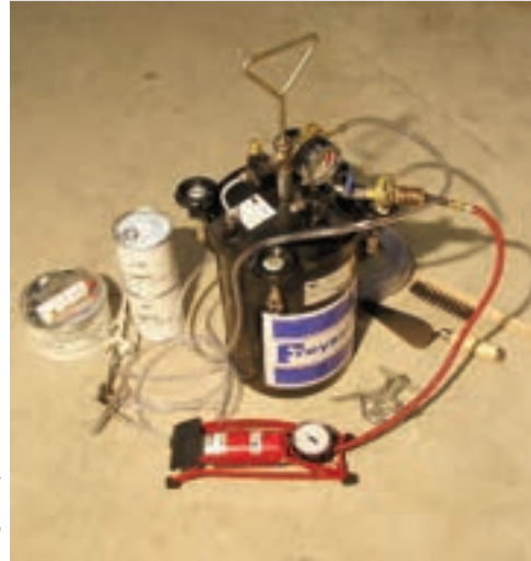
Photo n° 30 : préparation du matériel et des produits nécessaires à une injection (crédit photo Freyssinet)
