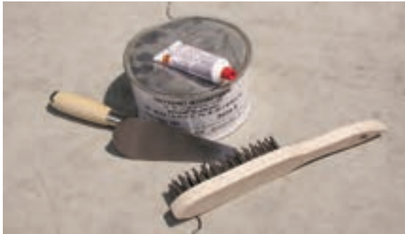
Photo n° 29 : matériel nécessaire au nettoyage des fissures et à leur cachetage (crédit photo Freyssinet)
