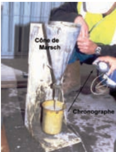
Photo n° 43 : mesure du temps d'écoulement (viscosité) d'un coulis d'injection au cône de March (crédit photo Parexlanko)
