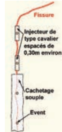
Figure n° 9 : détail de mise en place d'événements collés
