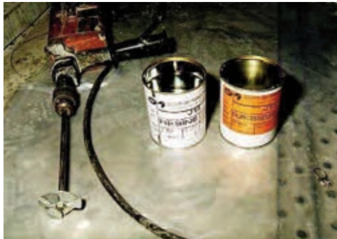
Photo n° 10 : étiquetage d'un pot de résine et d'un pot de durcisseur (crédit photo Séttra)
