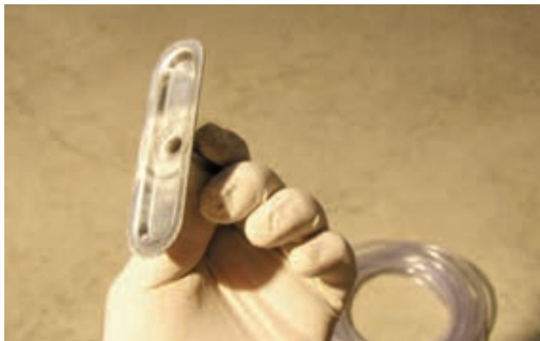
Photo n° 19 : injecteur plat ou cavalier (crédit photo Freyssinet)
