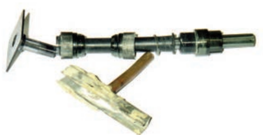
Photo n° 20 : autres types d'injecteurs collés (crédit photo Poineau)
