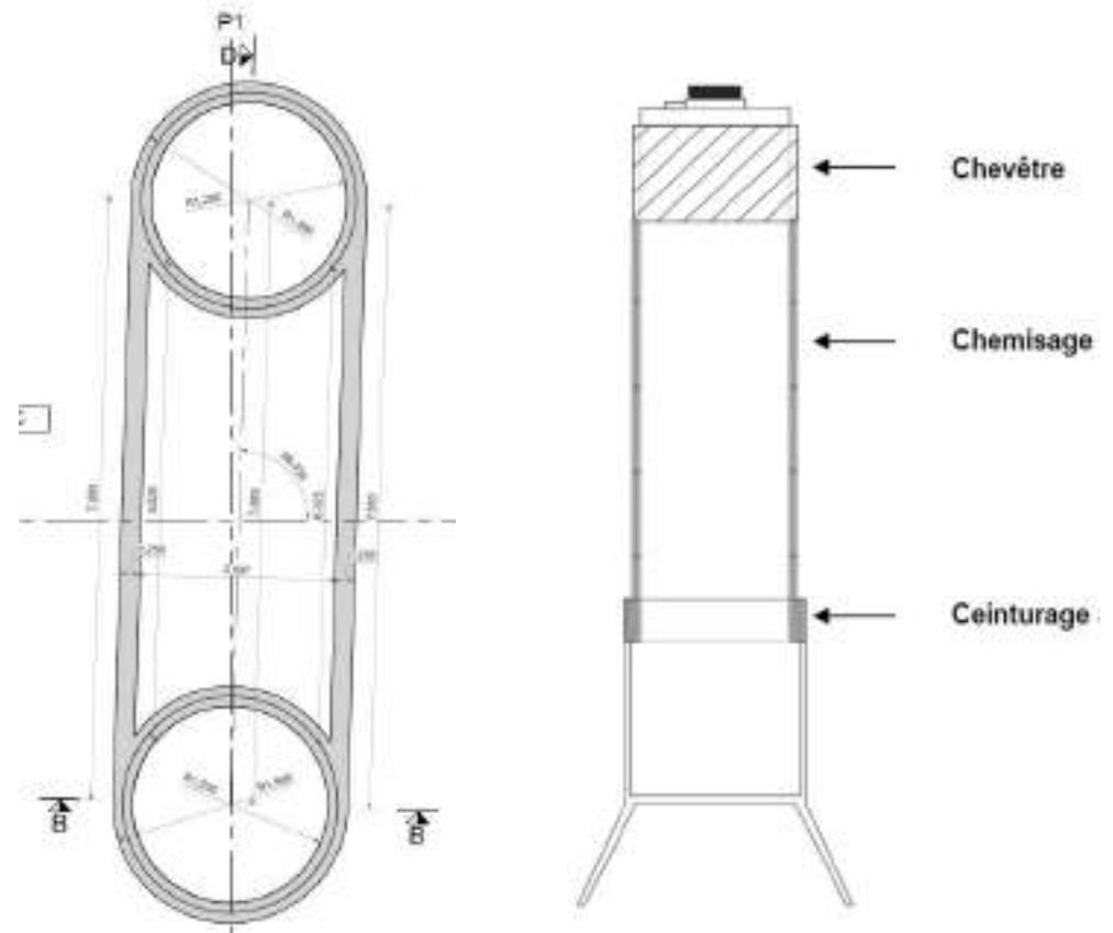
Vue en plan / Elévation sur Futs de piles
